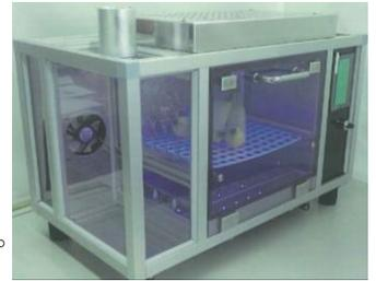
徳島大学大学院ソシオテクノサイエンス研究部と共同開発した。装置は可視光および紫外のLEDパッケージを搭載したハイブリッドLEDシステム、金属板に光触媒を塗布した光触媒シート、阿波製紙製の放熱フィン、空気循環システムなどで構成される。可視光LEDで光触媒を活性化して、生鮮食品から発生する腐食性ガスを分解しつつ、紫外LEDで殺菌効果を付与した。試作機には7個×7列のLEDパッケージを装置の上下と背面に設置した。この装置でバナナの表皮の変化を観察したところ、外に放置した場合と比較して黒ずみの進行を大幅に抑制できることが分かった。（「半導体産業新聞」2013.11.20より）
